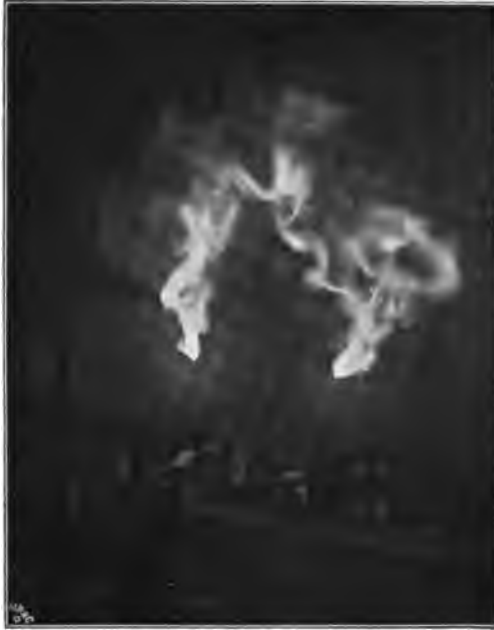
Abb. 87. Lichtbogen einer Hörnerblitzschutzvorrichtung kurz vor dem Verlöschen.
